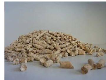
Piccoli cilindri da 5-45 mm ottenuti pressando segatura e trucioli di scarto.
